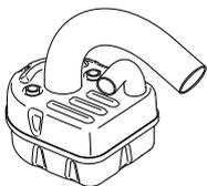
В странах с жарким и сухим климатом вероятность возникновения пожаров очевидна. Мы поэтому оснастили глушитель сеткой искроулавливателя, смонтированной внутри глушителя.
